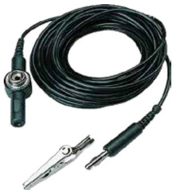
Наращиваемый узел на разъёме штекера типа "банан" / кнопка 10 мм, резистор безопасности 1 МОм, встроенный в кнопку, длина 3,0 м, штекер типа "банан"
