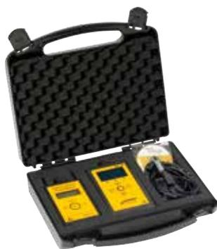
Стартовый тестовый набор предназначен для тестирования проводящих и рассеивающих поверхностей, измерения напряженности электростатических полей и определения величины статических зарядов
