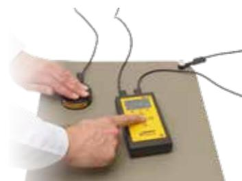
Набор для проверки сопротивления проводящих и рассеивающих поверхностей
